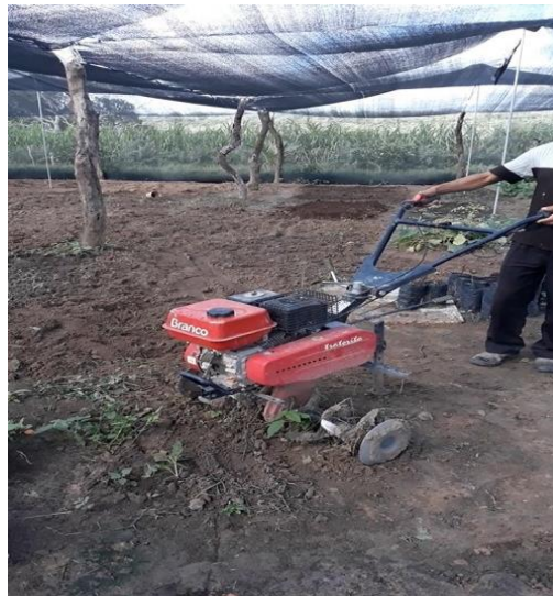
Figura 7. Cultivador a gasolina utilizado no preparo do solo dos sistemas produtivos do Sítio São Domingos, em Jaçanã, RN.
