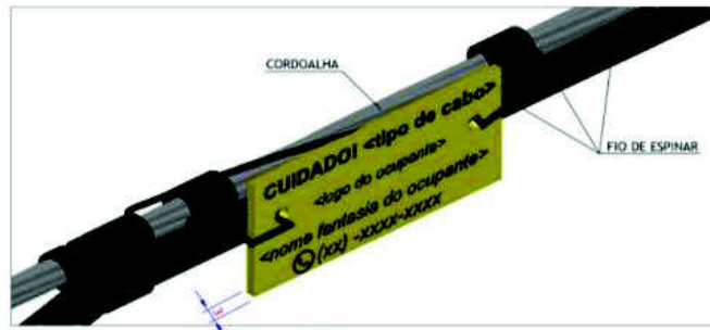
Fixação de plaqueta em cordoalha com fio de espinar.
