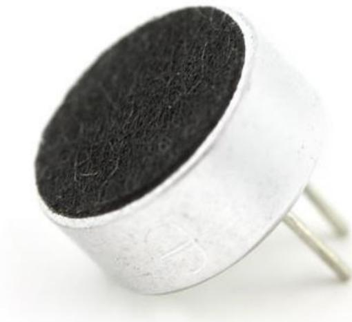
Figura 6 - Microfone de Eletreto. Fonte: <http://www.bosontreinamentos.com.br/wp-content/uploads/2018/07/microfone-eletreto-sparkfun.jpg>.
