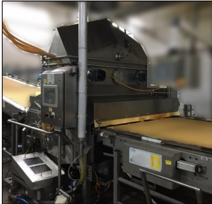
Figura 15 - Visão direita da máquina de pulverização de óleo.
