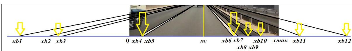
O próximo passo é identificar o primeiro grupo à esquerda e o primeiro grupo à direita. Admitindo-se que a câmera esteja posicionada, aproximadamente, no centro do para-brisas e direcionada para o ponto de fuga, encontra-se o valor central da abscissa  $xc$  que divide a ROI em duas partes iguais pela Equação (34).
