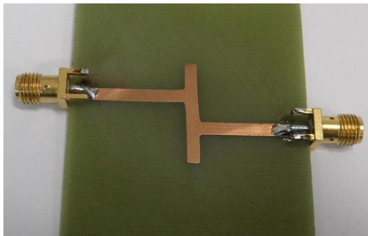
Figura 4.13 – Protótipo construído (FR4).
