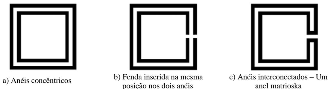
Figura 7 – Geometria matrioska passo a passo [29].
