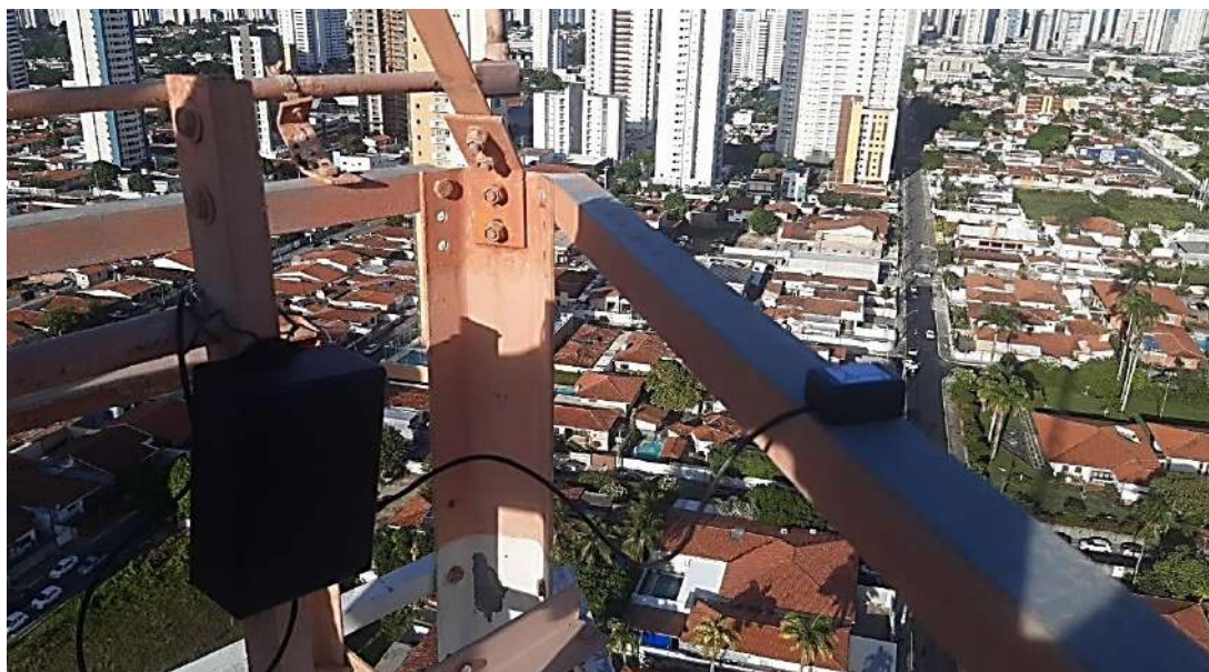
Figura 32: Dispositivo Vibrômetro fixado a 75 m na torre.
