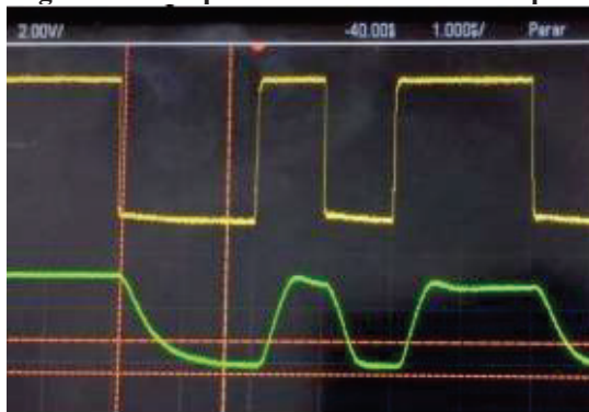
Figura 31 - Resposta do circuito fotorreceptor.
