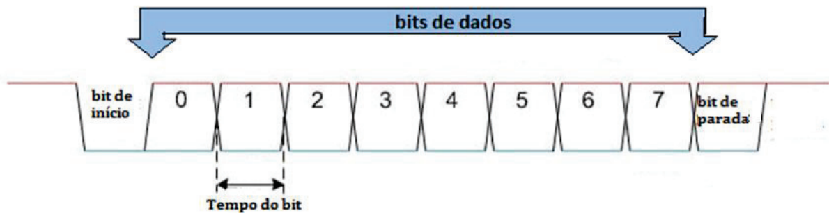
Figura 16 - Padrão de bits do protocolo UART.
