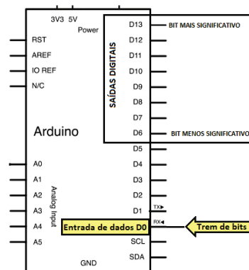
Figura 20 - Saídas digitais utilizadas no Arduino receptor.
