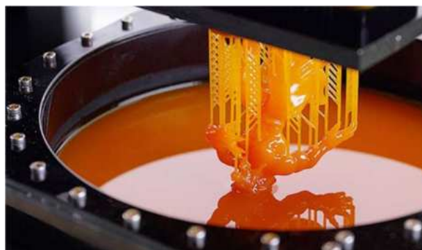
Figura 22 - Impressão do tipo Stereolithograph (SLA).
