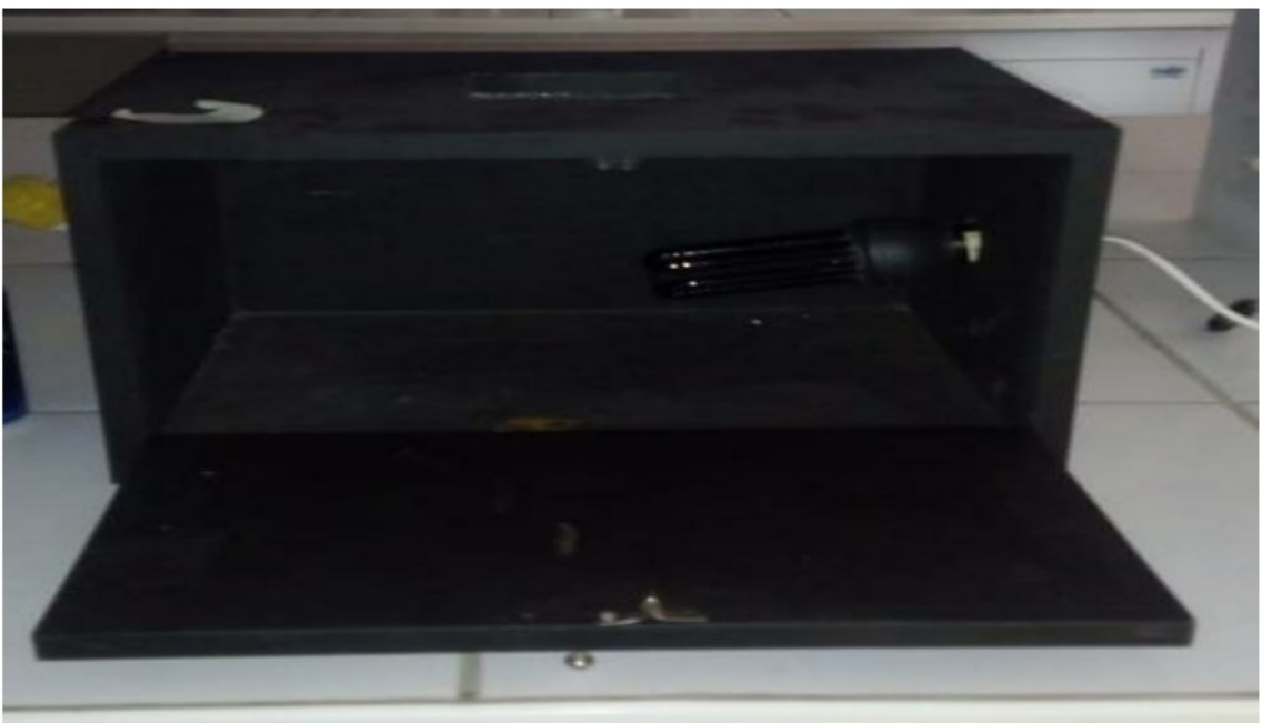
Figura 16: Câmara de raios ultravioleta parte interna
