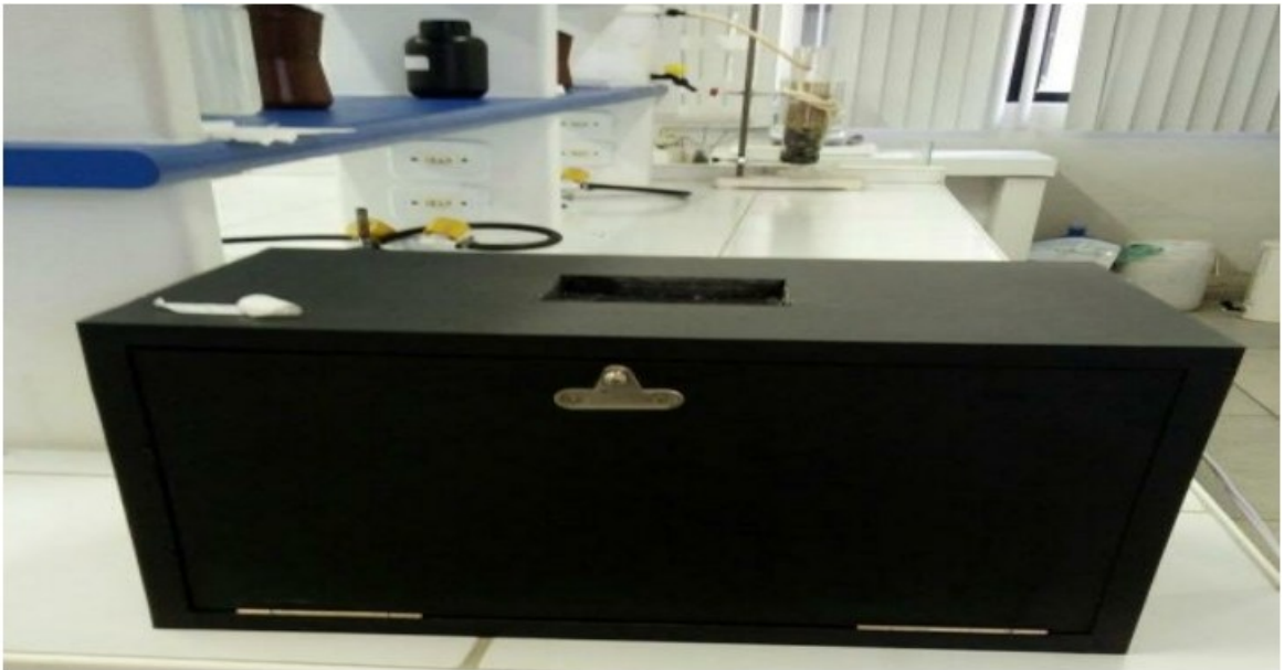
Figura 15: Câmara de raios ultravioleta parte externa
