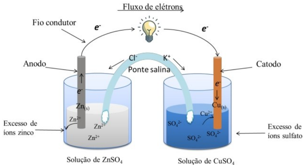
Figura 3: Esquema eletroquímico da pilha de Daniell. FONTE: Adaptado de Chang e Goldsby, 2013.
