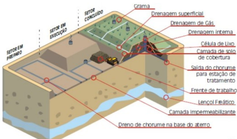
FIGURA 10: Corte da seção de um Aterro Sanitário
