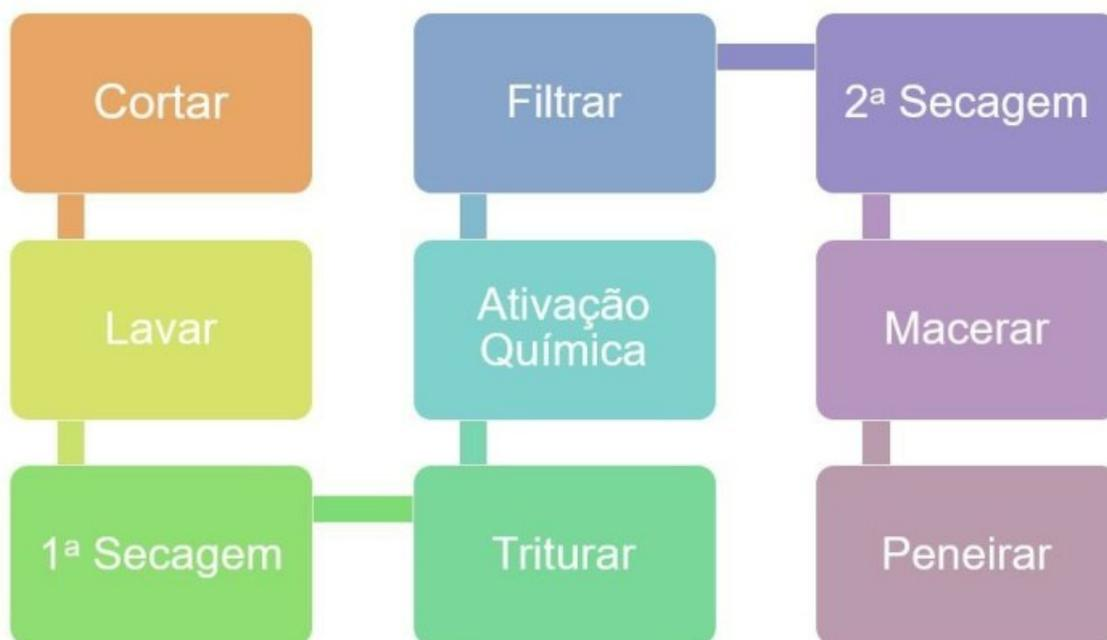
Diante os testes realizados pela pesquisadora com os três materiais (água deionizada, ácido clorídrico e hidróxido de sódio), pôde-se concluir que a adição do hidróxido de sódio possibilitou a neutralização das cargas positivas presentes na superfície da casca da banana, o que evita interações repulsivas entre as cargas positivas da superfície com os cátions que se deseja adsorver, assegurando uma adsorção mais satisfatória. Dessa forma, Sousa (2015, p. 58) afirma que:
