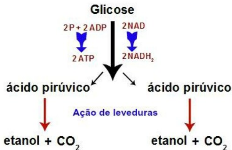
Figura 9- Obtenção de etanol e dióxido de carbono Fonte: Dias,2017
