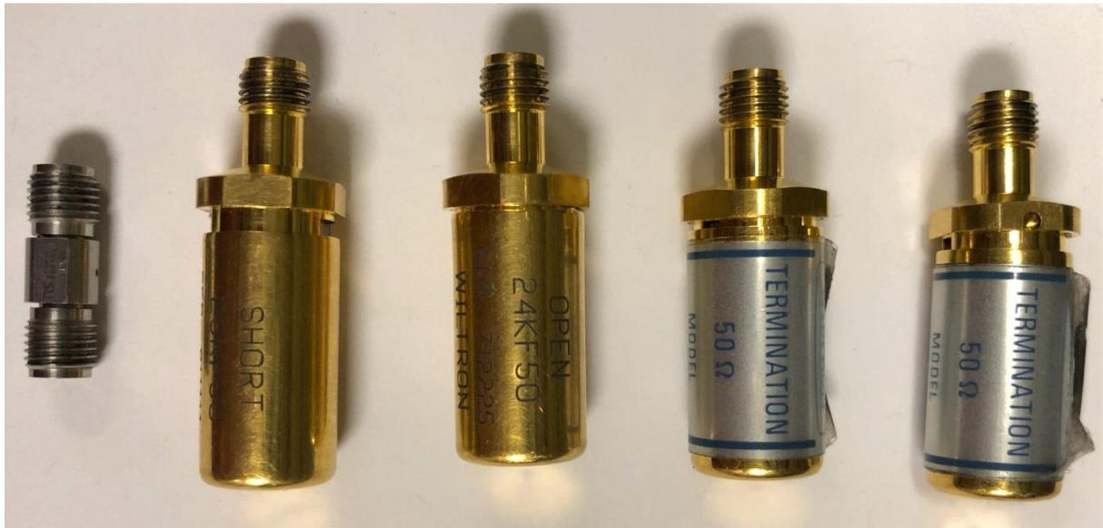
Figura A- 1 – Padrões passivos de calibração SOLT utilizados
