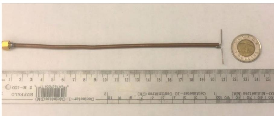
Figura 5- 8 – Dipolo fabricado
