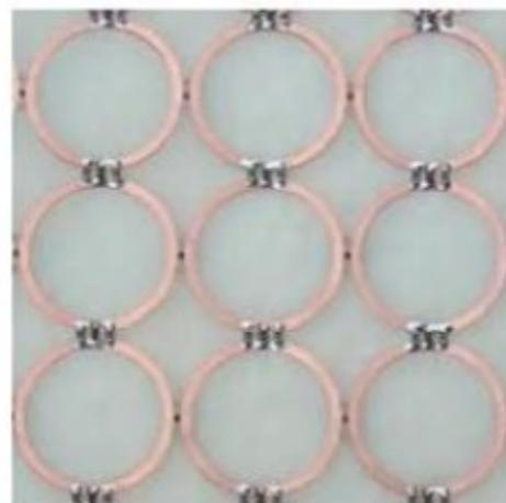
(b) FSS reconfigurável com geometria em forma de anéis de dupla polarização [26].
