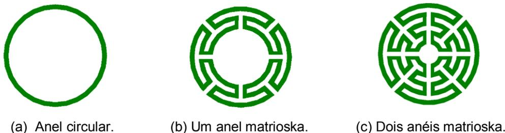
Figura 3.1 — Célula Básica da geometria matrioska.
