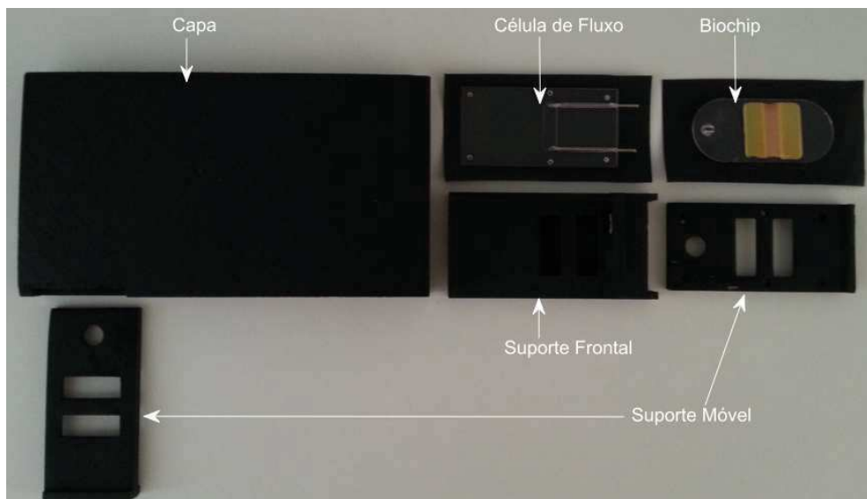
Figura 24 – Visão traseira dos componentes da estrutura mecânica Capa.
