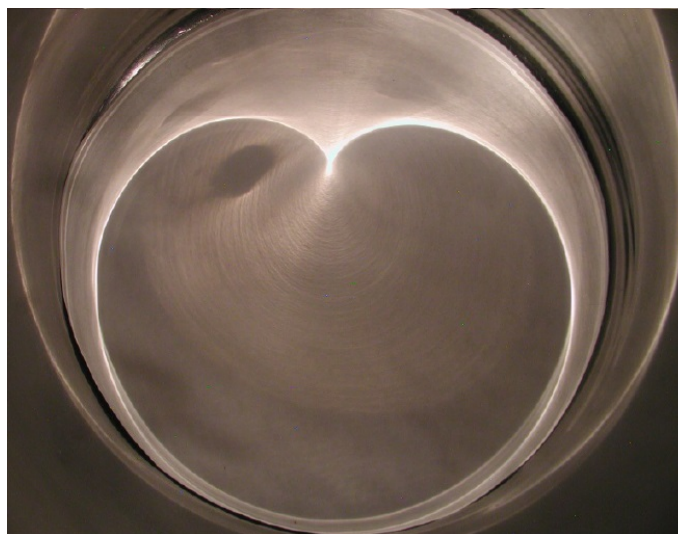
Figura 3.2: Geração de curva catacáustica (cardioide) de uma circunferência por reflexão da luz em superfície metálica.
