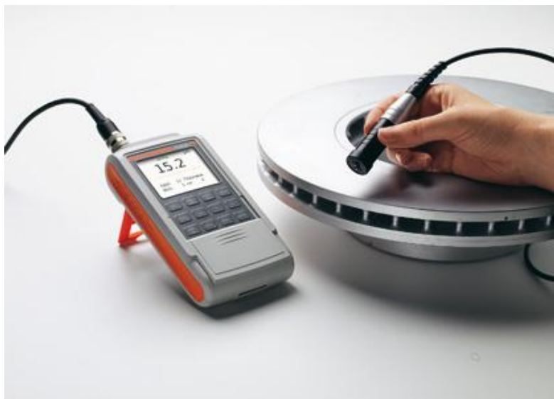
Figura 2: Ferritoscópio desenvolvido pela Helmut Fisher.
