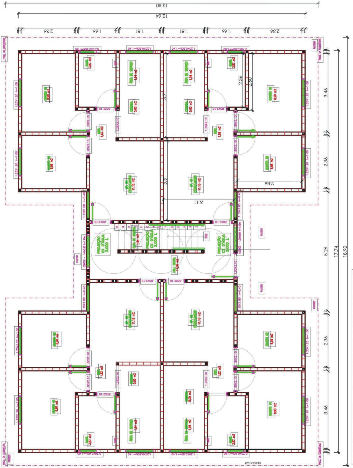
PLANTA BAIXA (ALVENARIA ESTRUTURAL)
