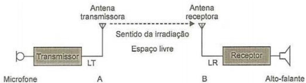
Figura 11 – Diagrama em blocos de um radioenlace.
