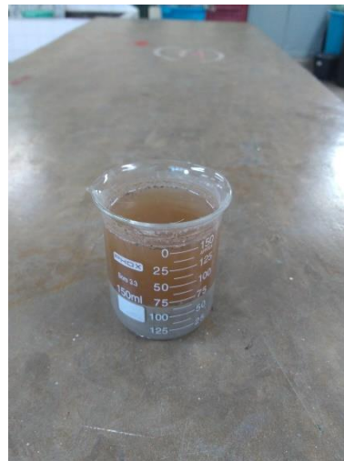
Figura 19 – Etapas do ensaio de granulometria por sedimentação. a) amostra imersa na solução, b) amostra após 12h de imersão, c) amostra no aparelho dispersor, d) leitura do densímetro e verificação da temperatura.
