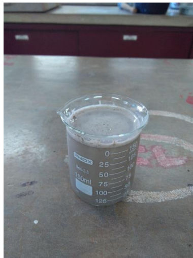
Figura 19 – Etapas do ensaio de granulometria por sedimentação. a) amostra imersa na solução, b) amostra após 12h de imersão, c) amostra no aparelho dispersor, d) leitura do densímetro e verificação da temperatura.
