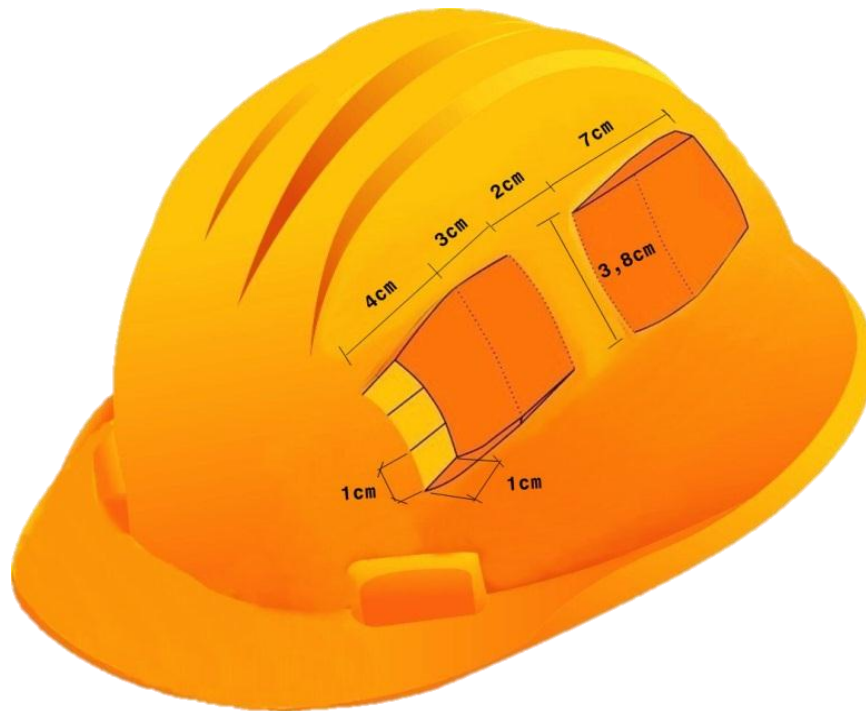
Figura 9 – Capacete proposto com sistema de ventilação
