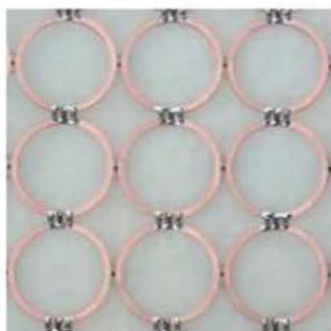
(a) FSS reconfigurável com geometria em forma de anéis de dupla polarização
