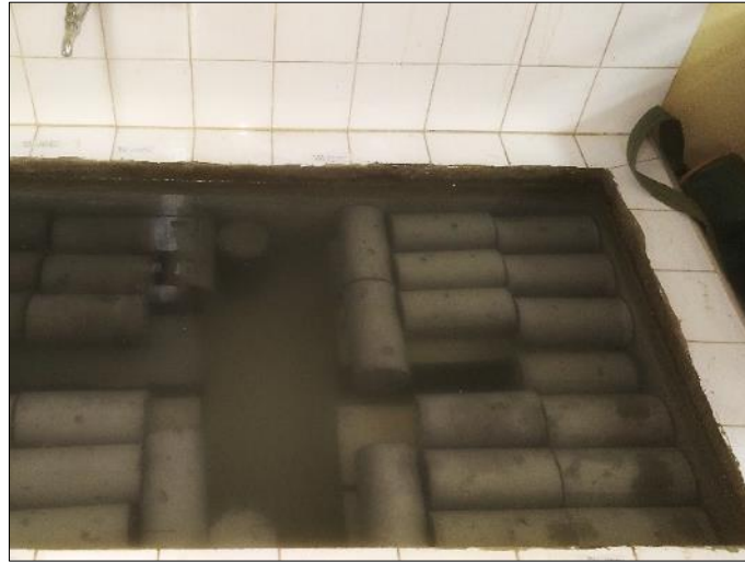
Figura 16 - Tanque de Cura.
