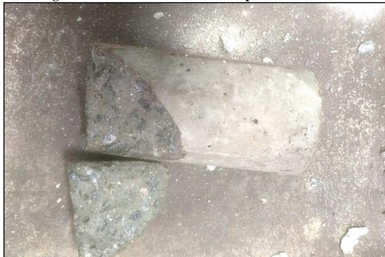
Figura 30 - Falha em ensaio de compressão diametral.
