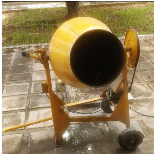
Figura 13 - Mistura mecanizada de concreto em betoneira.
