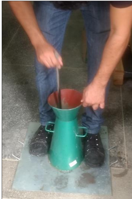
Figura 22 - Execução do slump test.
