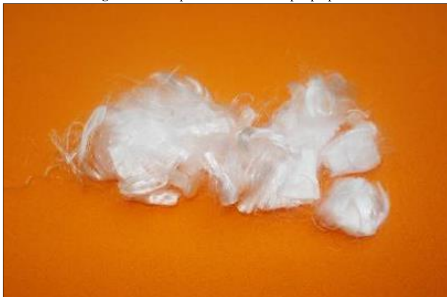
Figura 7 - Exemplo de microfibra de polipropileno.
