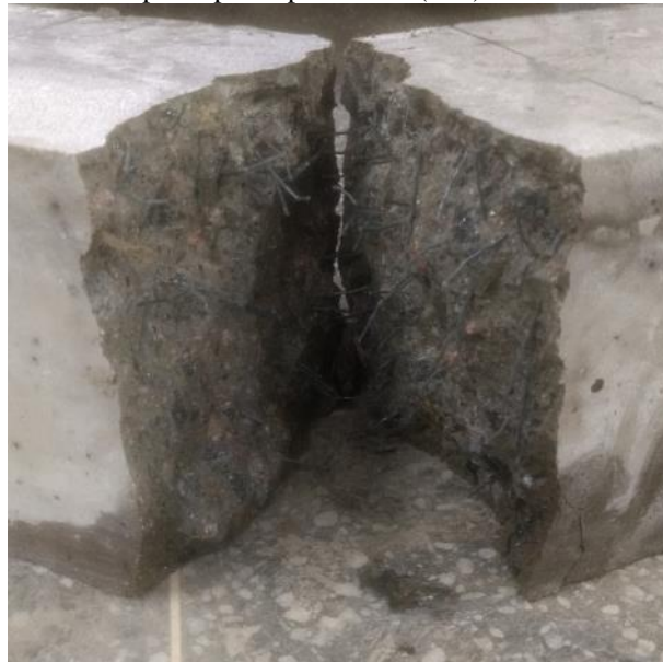
Figura 36 - Fratura de corpo de prova prismático (F05) em ensaio de tração na flexão.
