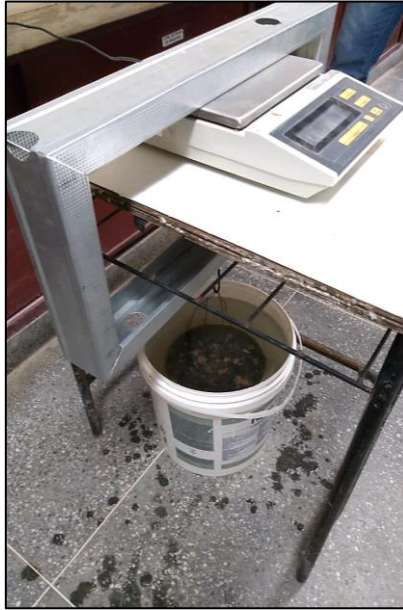
Figura 29 - Balança hidrostática adaptada.
