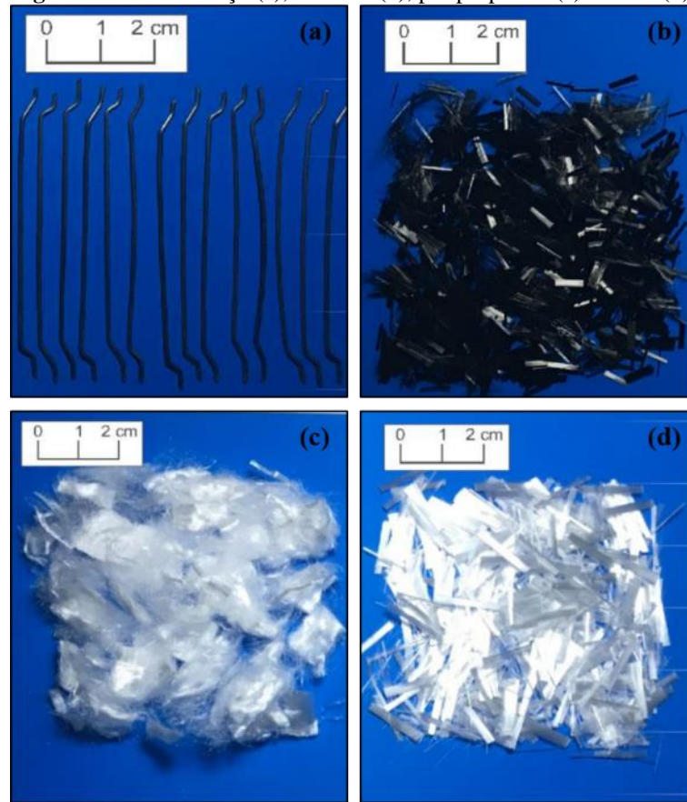
Figura 1 - Fibras de aço (a), carbono (b), polipropileno (c) e vidro (d).
