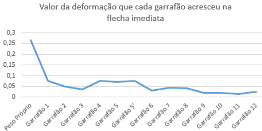
Gráfico 1: Valores da deformação, em mm, que cada garrafão com água contribuiu para a flecha imediata.
