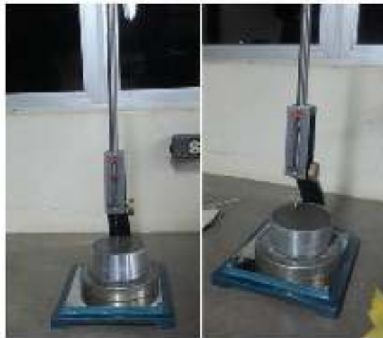
Figura 17: Ensaio tempo de início e fim de pega utilizando o aparelho de Vicat.
