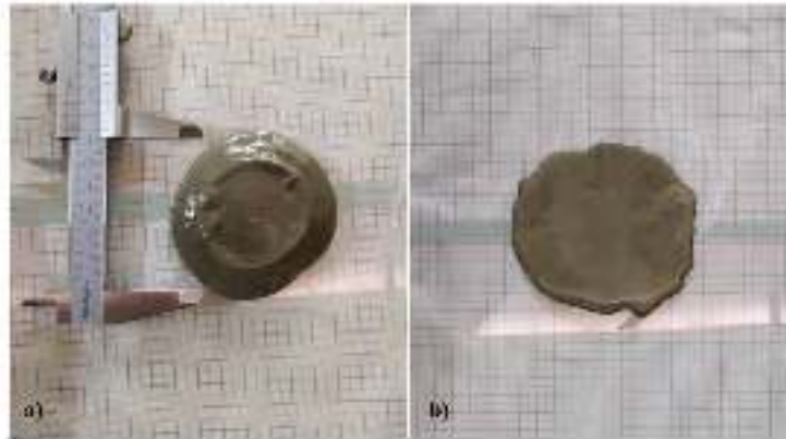
Figura 42: a) Aferição dos diâmetros perpendiculares da pasta; b) Desuniformidade dos diâmetros e exsudação da pasta.
