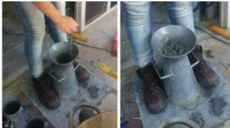
Figura 33: Ensaio de consistência do tronco de cone- slump test .
