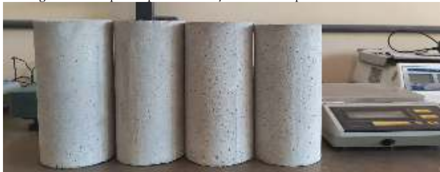
Figura 39: Corpos de prova dos traços T0 e T10 após 72 horas em estufa.
