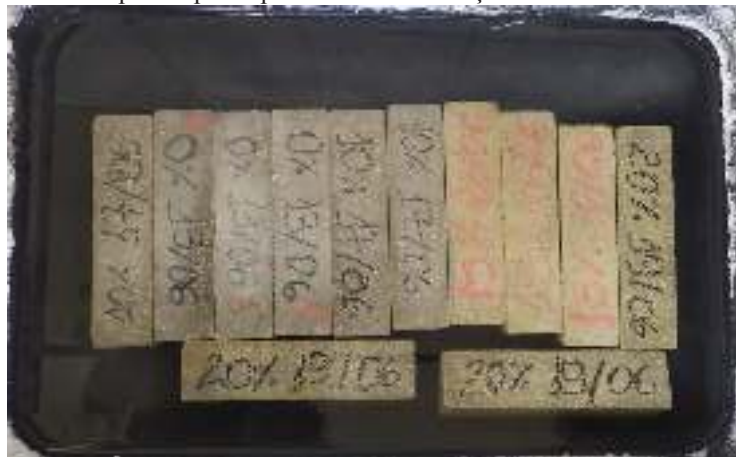
Figura 38: Corpos de prova prismáticos em solução de sulfato de sódio anidro.
