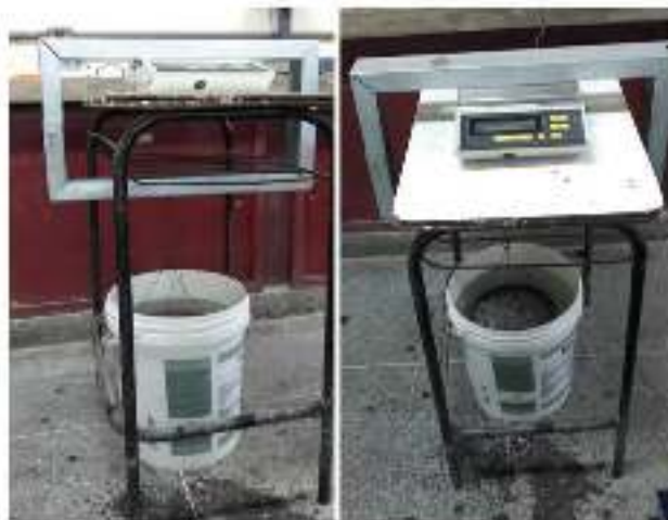
Figura 13: Balança hidrostática adaptada.
