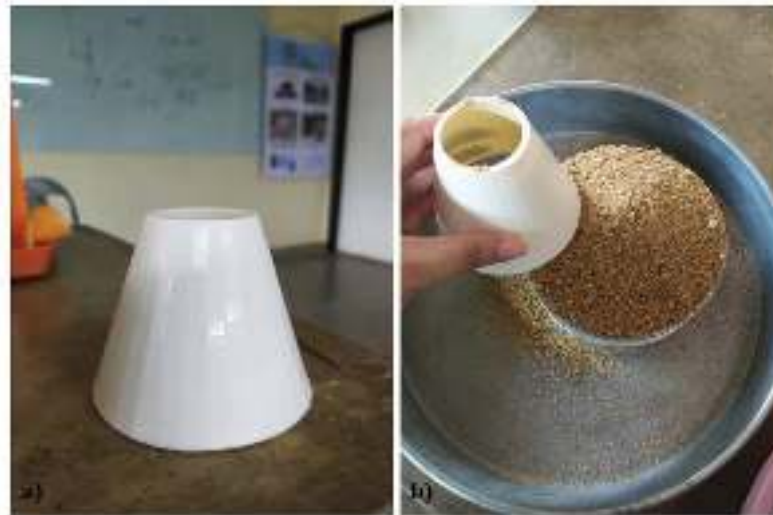
Figura 12: a) Molde de tronco de cone; b) Desmoronamento do agregado após retirada do molde.
