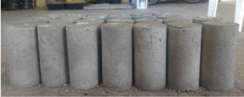
Figura 28: Corpos de prova do traço de referência desmoldados após 24 horas da moldagem.
