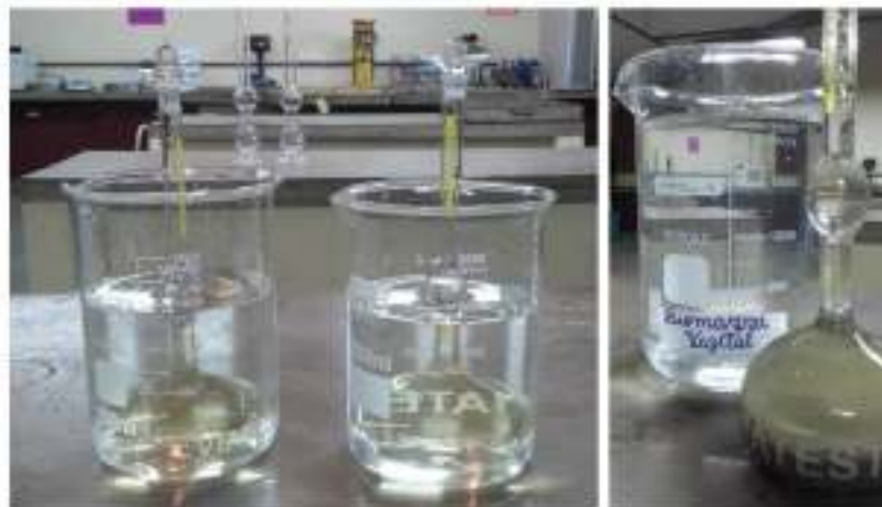
Figura 19: Determinação da massa específica da cinza de biomassa vegetal.
