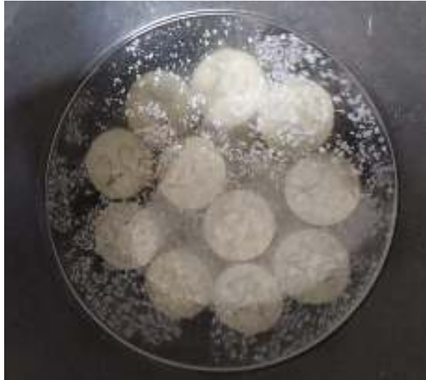
Figura 30: Cura em solução de sulfato de sódio anidro.
