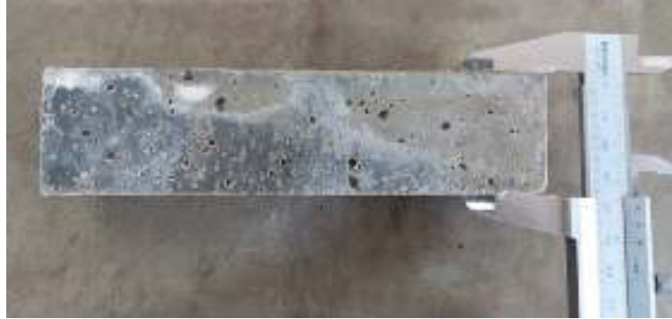
Figura 37: Medição dos corpos de prova prismáticos com auxílio de paquímetro.
