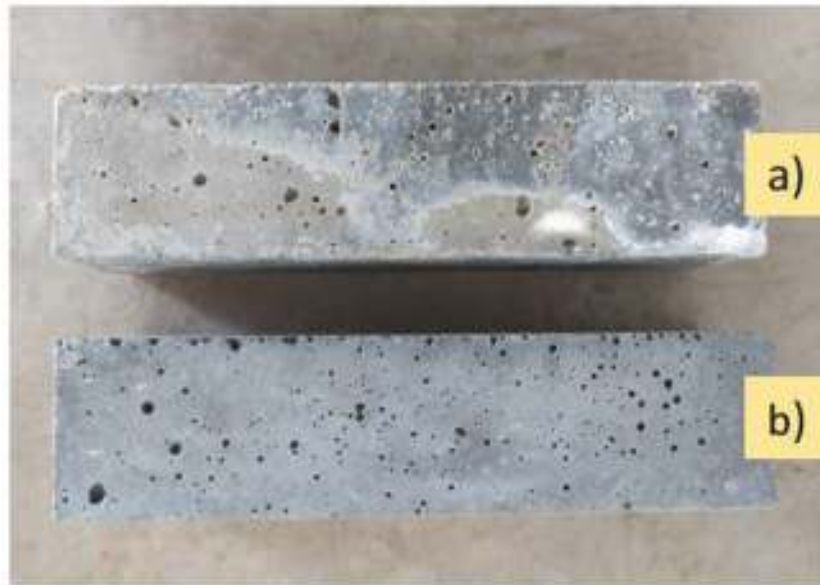
Figura 48: a) Argamassa atacada pelo sulfato em comparação a b) argamassa curada em solução de água saturada com cal.
