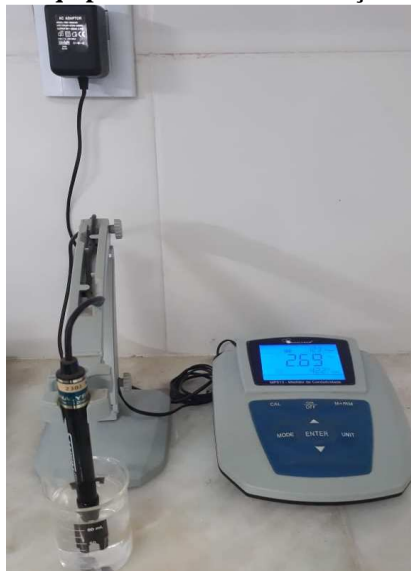
Figura 8: Equipamento usado na aferição dos SDT.
