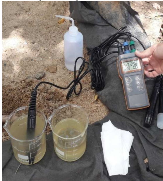
Figura 9: Medição in loco para CE, Salinidade, OD e pH.
