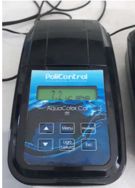
Figura 6: Colorímetro portátil usado na quantificação da CV.
