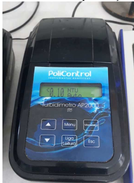
Figura 7: Turbidímetro usado na quantificação da Turbidez.
