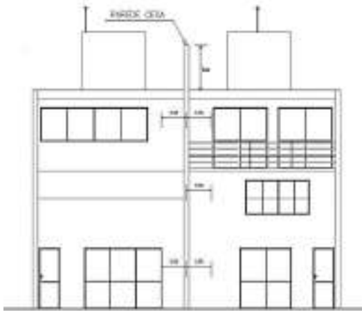
Figura 8: Exemplo de forma construtivo de parede cega
