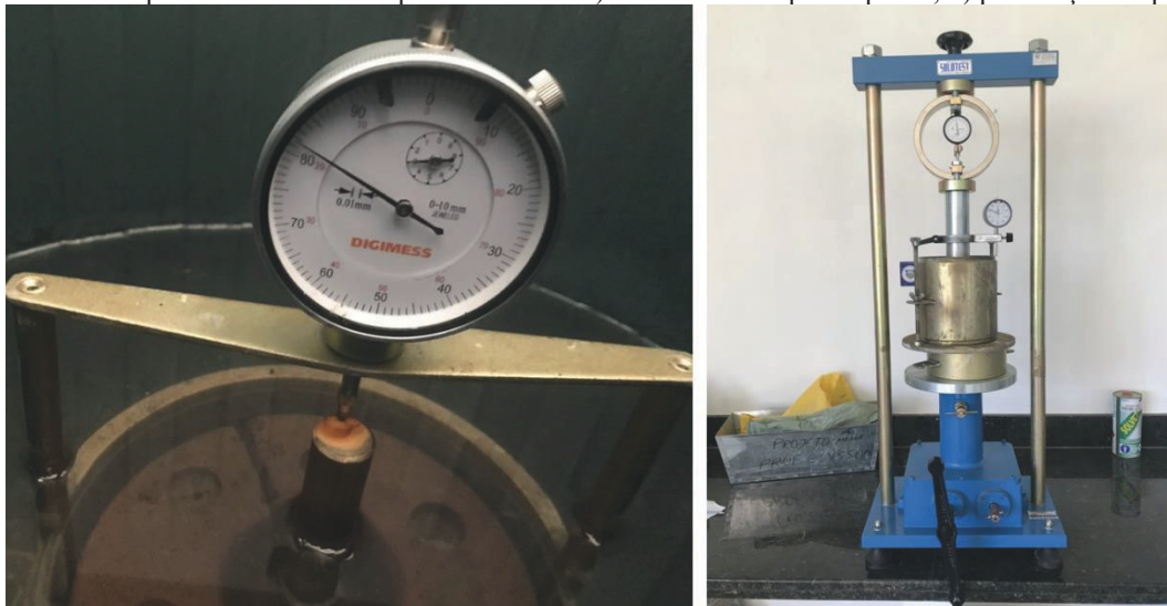
Figura 19 – Etapas dos ensaios de expansão e CBR: a) imersão do corpo-de-prova; b) penetração do pistão.
