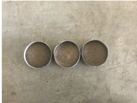
Figura 9 – Amostras utilizadas no ensaio de teor de umidade.
