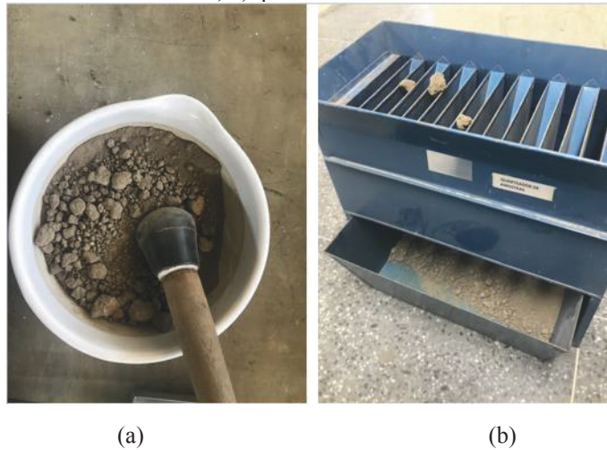
Figura 8 – Preparação das amostras para os ensaios de caracterização: a) destorroamento com a mão de gral e o almofariz; b) quarteamento da amostra.
