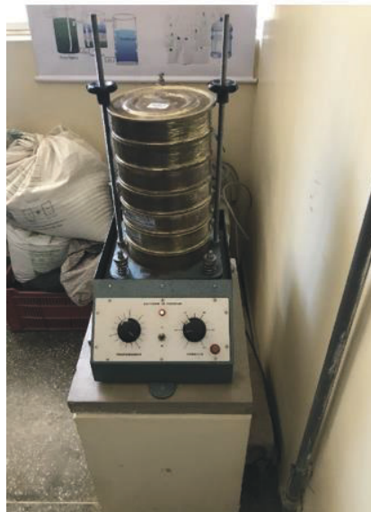
Figura 11 – Ensaio de granulometria por peneiramento com o auxílio do agitador de peneiras.
