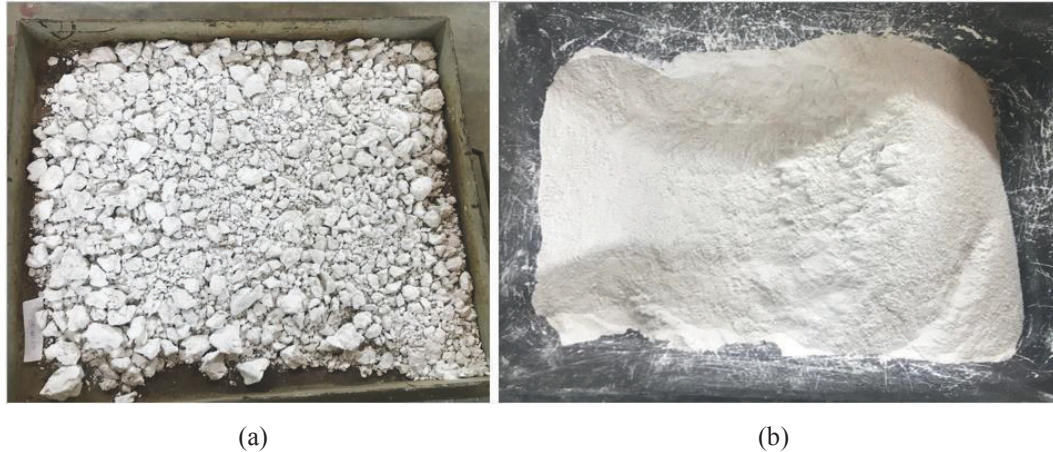
Figura 15 – Resíduo do Polimento do Porcelanato: a) material coletado; b) material depois de destorroado.
