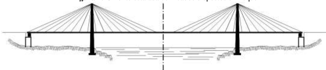
Figura 2.18 Ponte estaiada com cabos dispostos em leque
