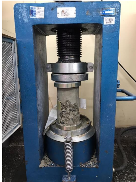
Figura 07 - Teste de resistência à compressão – Obra 02.
