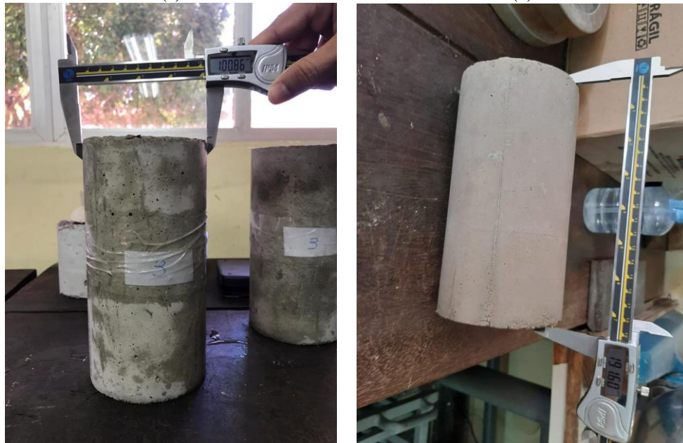
Figura 09 - (a) Medição do diâmetro e da massa e (b) Medição da altura nos corpos de prova – Obra 03.
