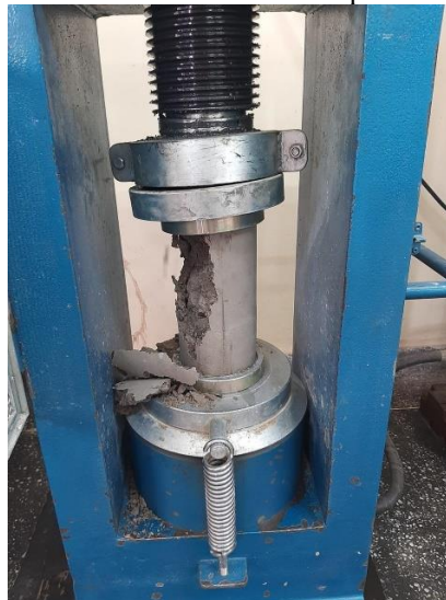
Figura 13 - Teste de resistência à compressão – Obra 04.
