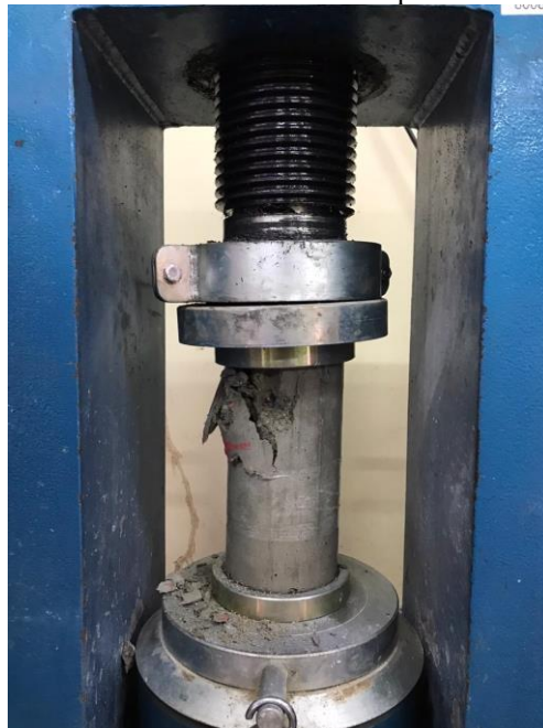
Figura 10 - Teste de resistência à compressão – Obra 03.
