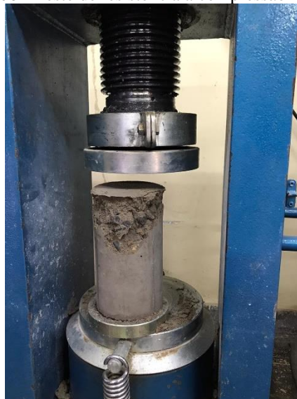
Figura 06 - Teste de resistência a compressão – Obra 01.
