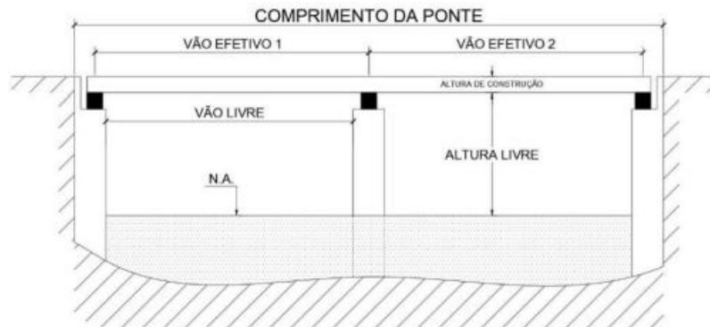
Figura 5 - Elementos da seção longitudinal.
