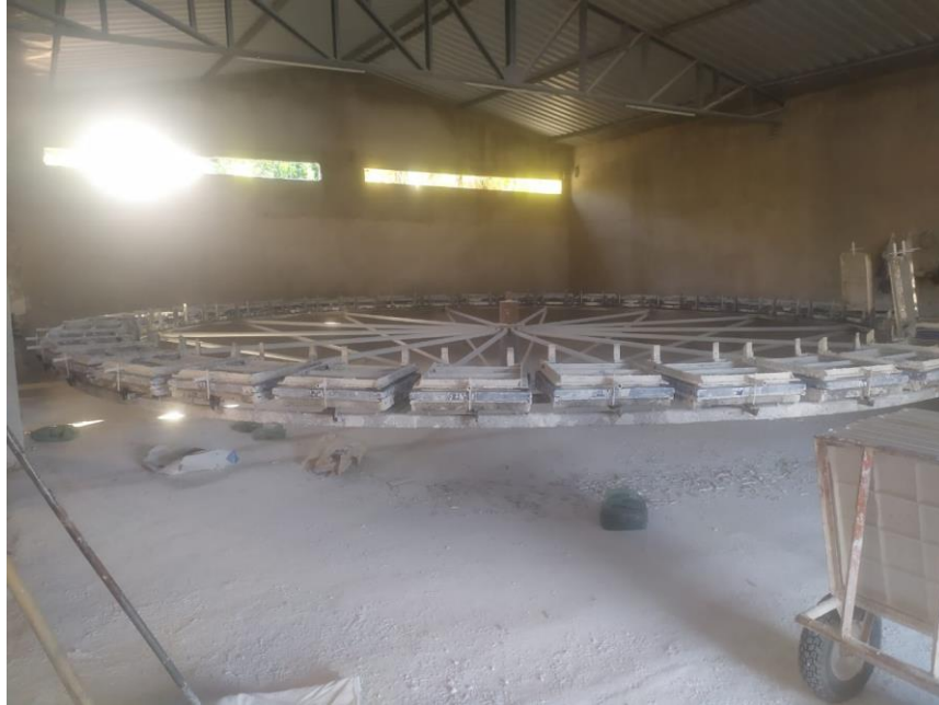
Figura 7 – Carrossel de 48 mesas com formas de silicone.
