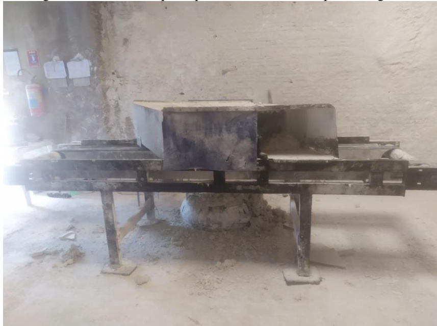
Figura 8 – Plaina, a máquina que dá o acabamento às placas de gesso.
