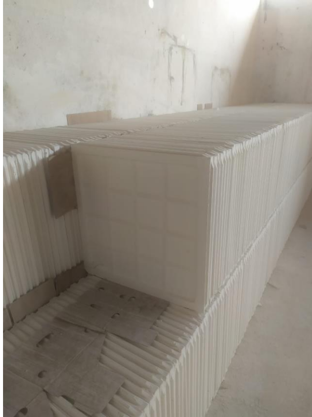
Figura 6 – Placas de gesso em um depósito.
