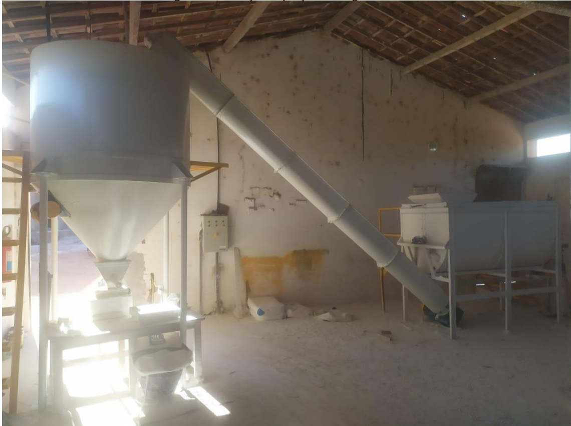
Figura 17 – Máquina que produz o gesso cola.
