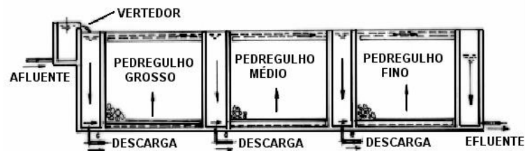
Figura 32 - Esquema de um pré-filtro ascendente em camadas (PFPAS)
