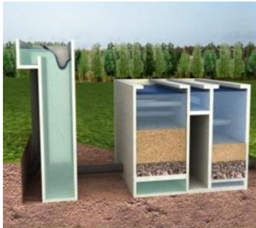
Figura 38 - Representação de dupla filtração
