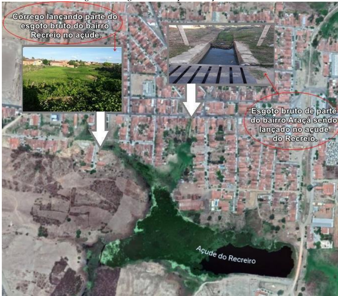
Figura 13 – Esgoto bruto lançado no Açude do Recreio
