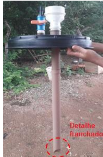
Figura 10 - Detalhamento do tubo alimentador do biodigestor.
