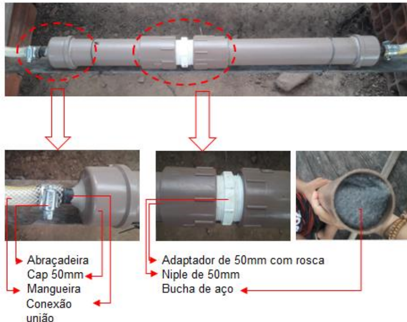
Figura 14 - Detalhamento do primeiro filtro.
