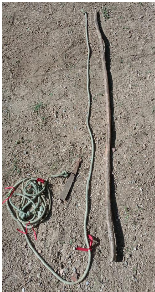
Figura 7: simulação de instrumento de marcação de terra, vara e corda.
