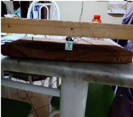
Figura 05 - Visão frontal da gôndola(versão madeira com sensor de 10Kg)
