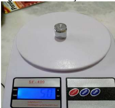
Figura 09 – Calibração de balança com peso padrão de 50g
