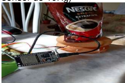
Figura 07 – Gôndola circular e microcontrolador ESP 32(versão madeira com sensor de 10Kg)
