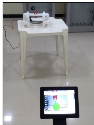
Foto 3 - Visor da câmera Daycor monitorando a detecção do efeito corona Fonte: acervo do Autor
