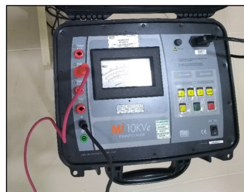
Foto 5 - Fonte de tensão CC até 10 kV Fonte: Acervo do Autor
