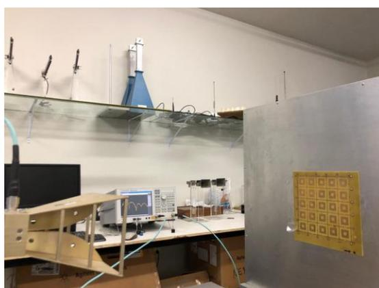
Figura 29 – Janela de medição sem absorvedores.
