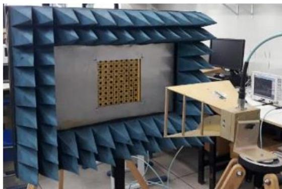
Figura 28 – Janela de medição com absorvedores.
