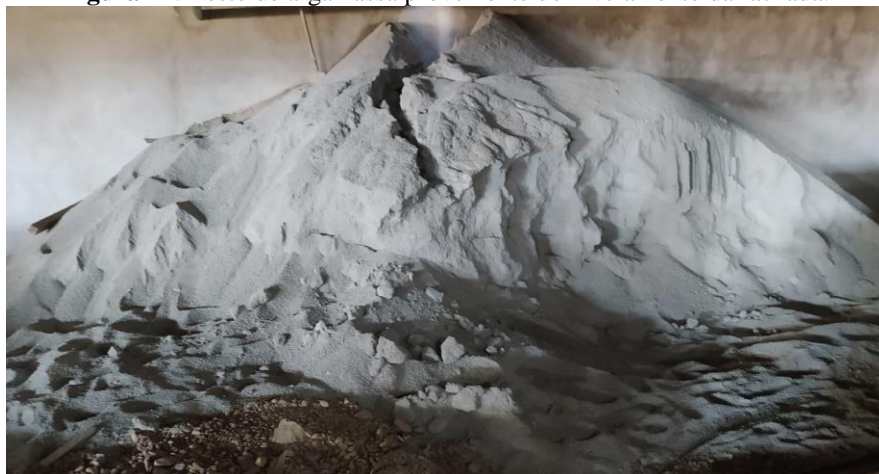
Figura 44: Resto de argamassa proveniente do nivelamento da fachada.
