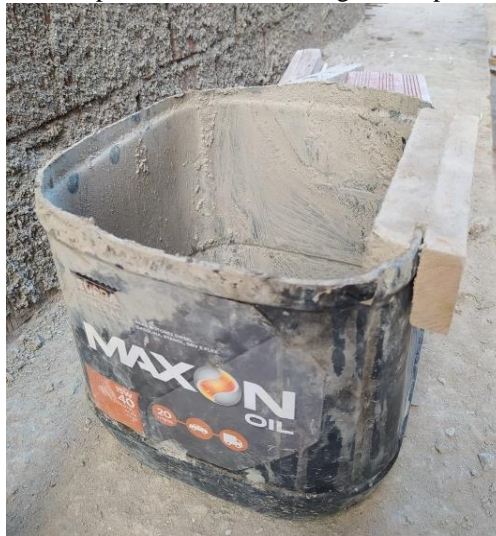
Figura 43: Balde proveniente da embalagem dos postos de diesel.
