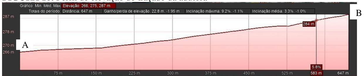
FIGURA 16: Perfil de elevação do traçado da adutora
