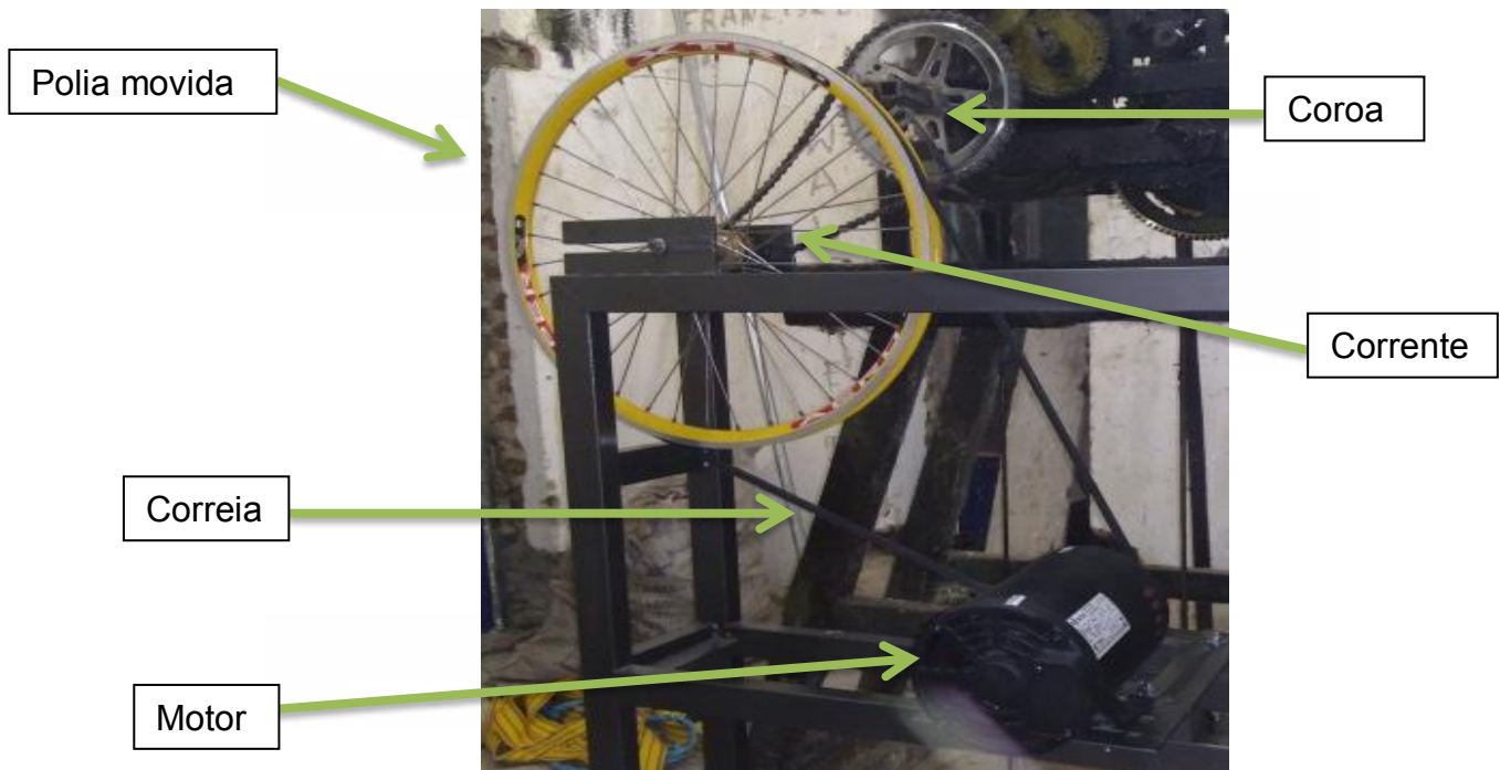
Figura 20: Identificação dos elementos dimensionados
