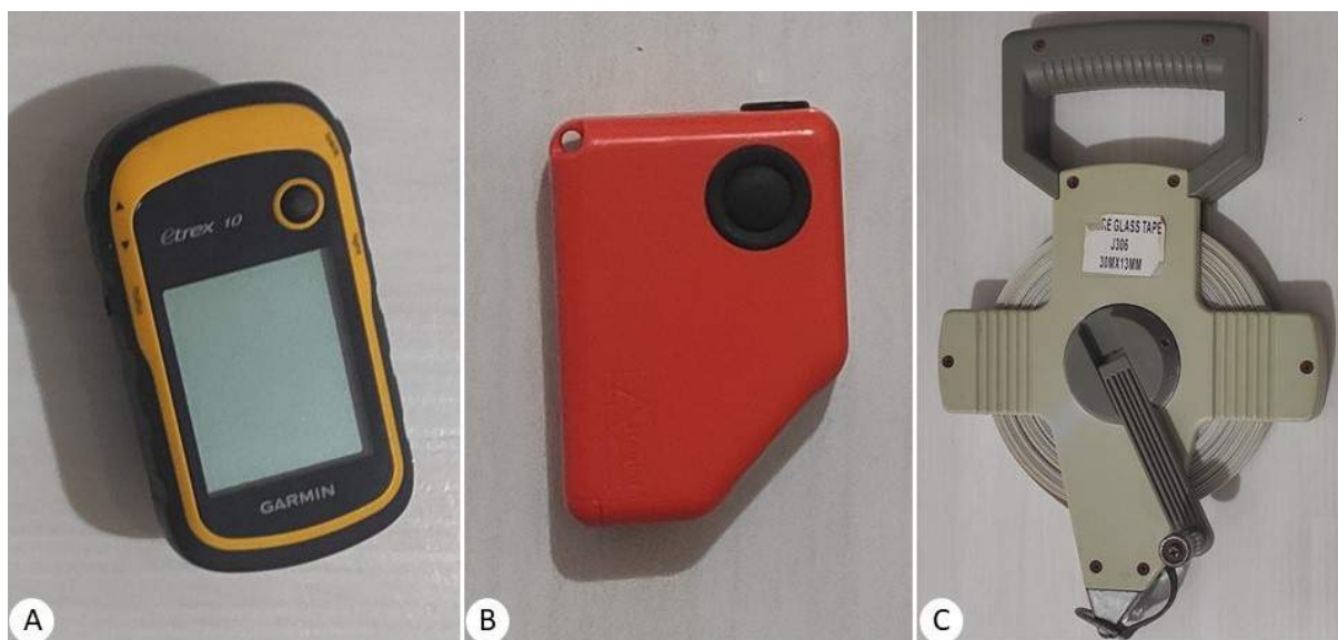
Figura 3. Instrumentos utilizados para a coleta de dados: (A) GPS Etrex 10 - Garmin®. (B) clinômetro eletrônico Haglöf®. (C) Fita métrica de 30 metros.
