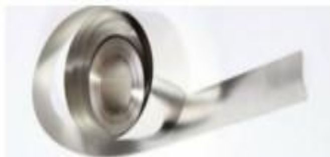
Figura 11 – Representação do material nanocristalino em fita.
