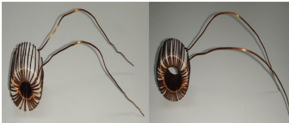
Figura 16 – Núcleos Nanocristalino bobinados NX e NY.
