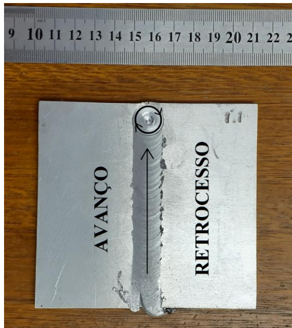
Figura 12: Vista superficial da Junta soldada 1
