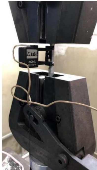
Figura 8: Fixação de corpo de prova para ensaio de tração uniaxial em garras da máquina universal de ensaios MTS, modelo 810.
