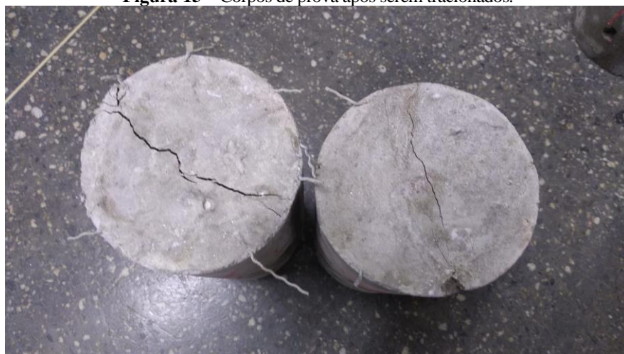
Figura 15 – Corpos de prova após serem tracionados.
