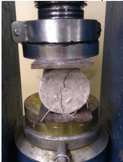
Figura 14 – Ensaio de resistência à tração com fibras.
