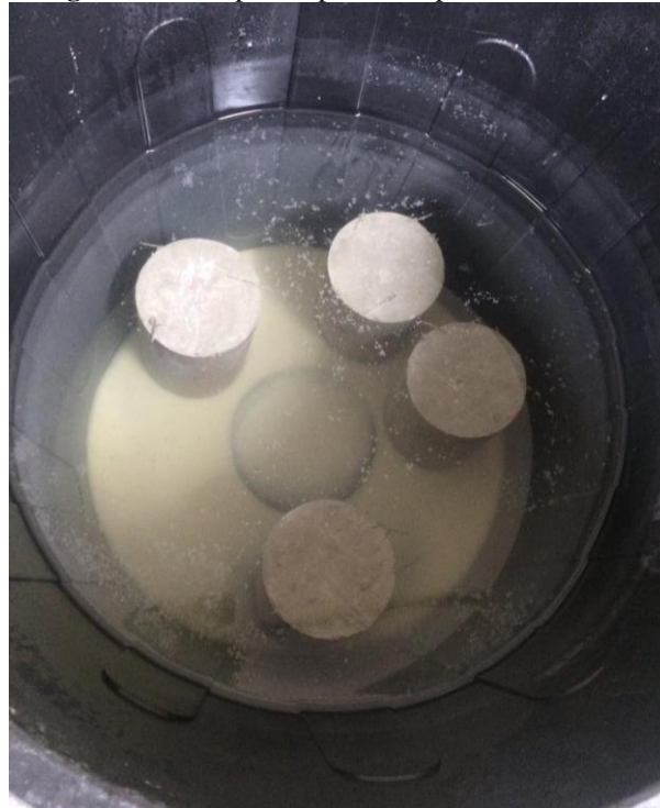
Figura 10 – Corpos de prova em processo de cura.
