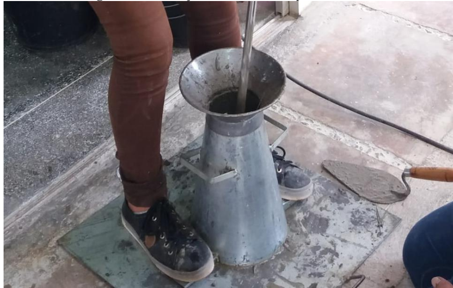
Figura 8 – Realização do ensaio de slump test .
