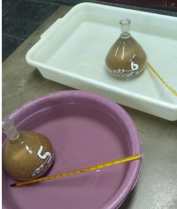
Figura 6 – Amostra em banho à temperatura constante.
