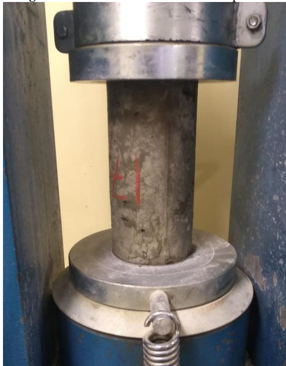
Figura 11 – Ensaio de resistência à compressão.
