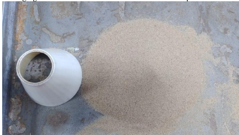
Figura 5 – Agregado miúdo ao lado do molde tronco-cônico após o desmoldamento.
