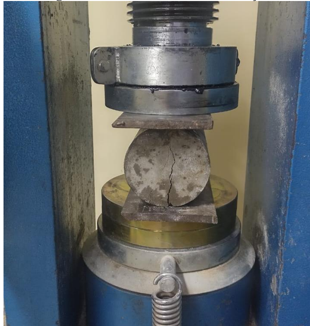
Figura 12 – Ensaio de resistência à tração.
