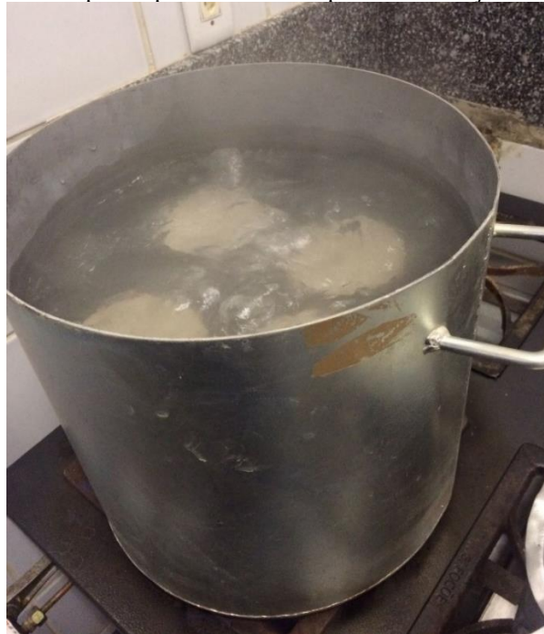
Figura 13 – Corpos de prova em fervura para determinação da absorção.
