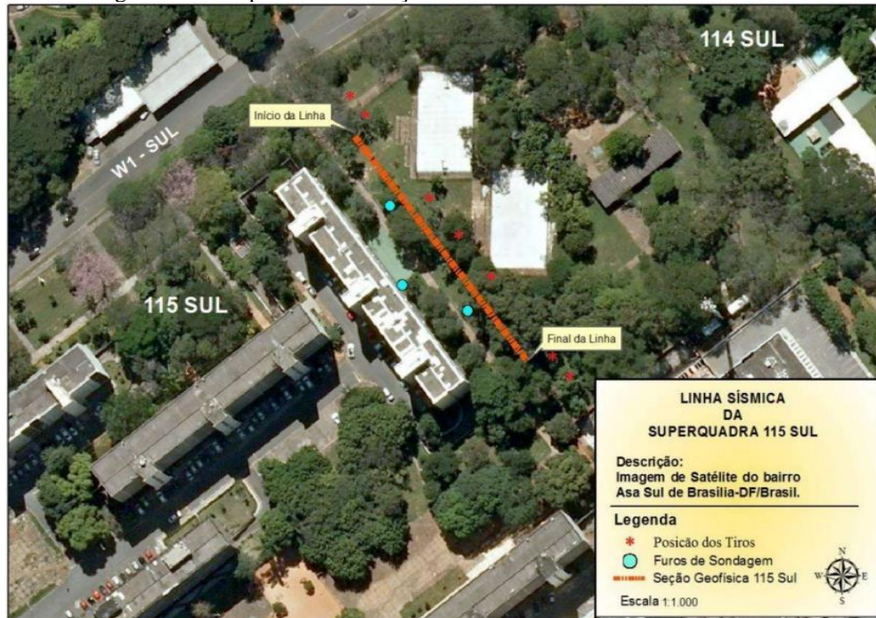
Figura 10 - Croqui com localização da linha sísmica realizada na 115 Sul.
