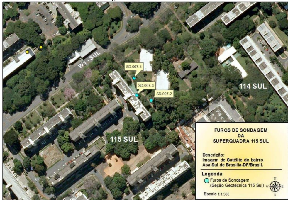
Figura 8 - Croqui com localização dos furos de sondagem utilizados para construção da seção geológico-geotécnica da 115 Sul
